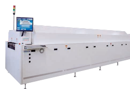
リフローはんだ付装置
