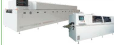
あらゆる電子機器に搭載されるプリント配線板に電子部品をはんだ付け接合する装置
