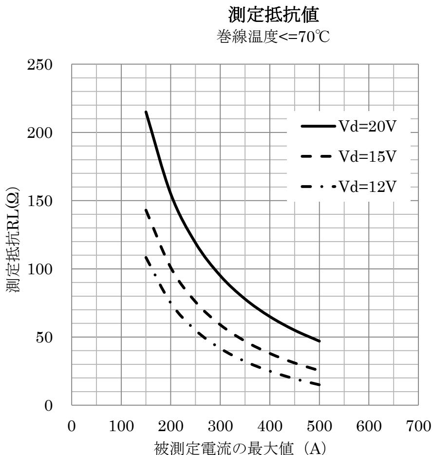
Fig7 測定抵抗の値 (巻線温度=70°C以下の場合)
