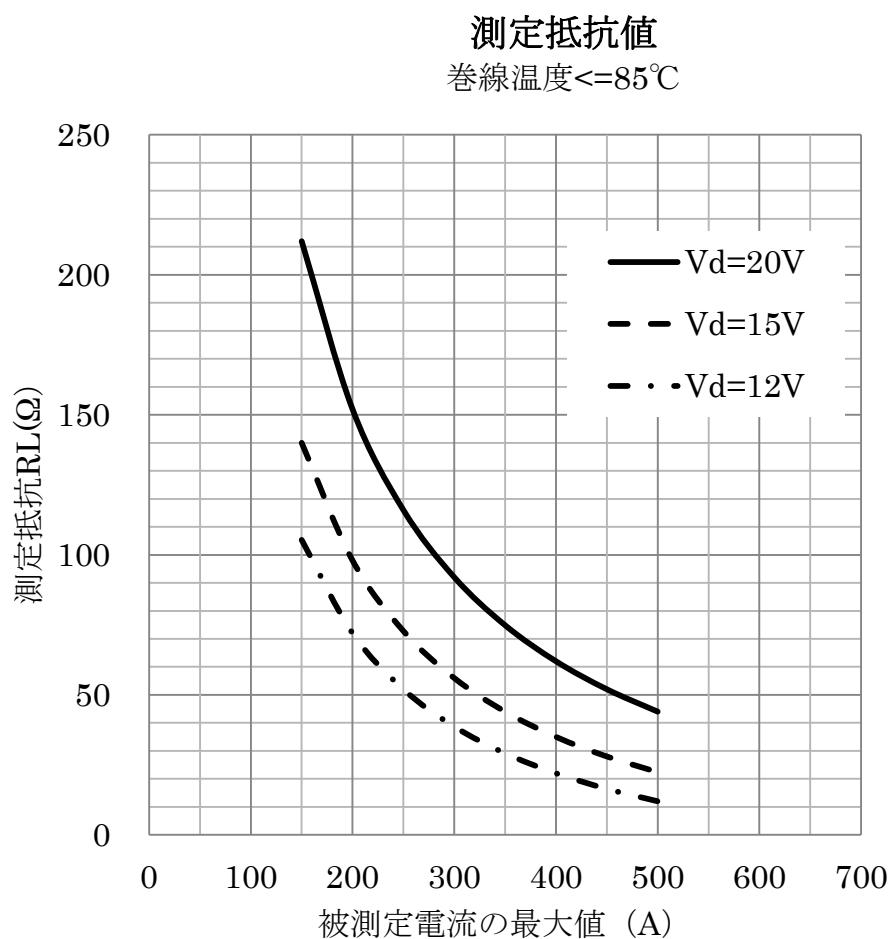
Fig8 測定抵抗の値 (巻線温度=85°C以下の場合)
