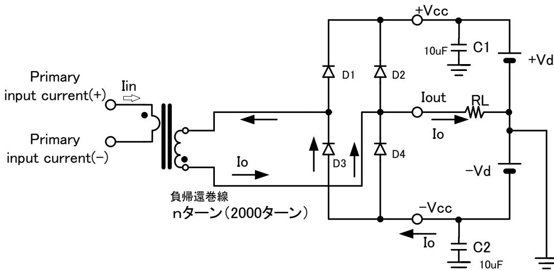
Fig4 カレントトランス動作の等価回路
