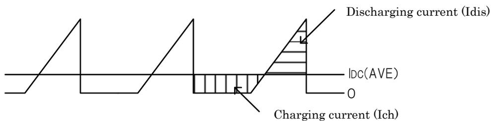
$$I_{\text{ripple}} = \sqrt{I_{dis}^2 + I_{ch}^2}$$
